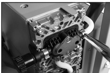
Vuelva a disponer la unión de manguera de la manguera de conexión con el otro lado de la bomba en el bloque de válvulas.
