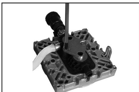
Suelte las placas de sujeción de las válvulas.
